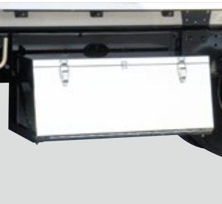
24 工具箱ステンレス製 L=750
