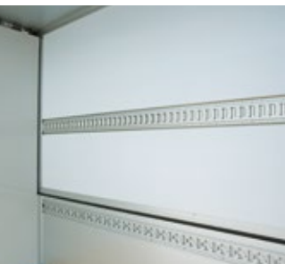
18 サイド内板ブラパール(白)張り
