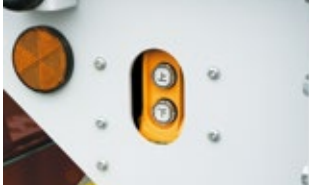
パワーユニット操作装置
