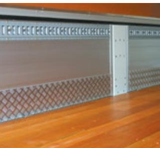
17 腰板(写真はアルミ縞板)
