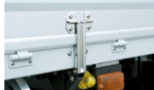
アオリ開閉補助装置(ステンレス製アーム)
