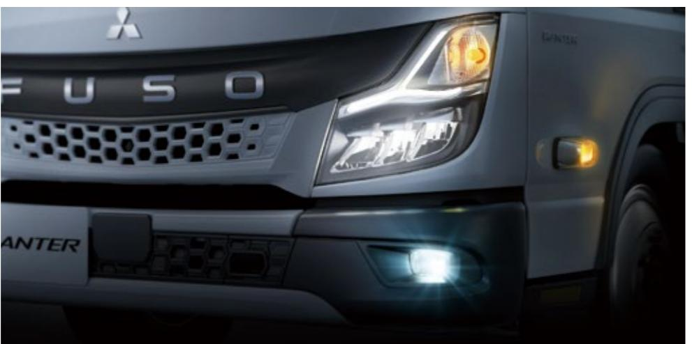
ヘッドライト、ドア側サイドターンランプにLEDを採用し、さらにLEDフォグランプも設定しています。白く明るい光で夜間の視認性を高め、障害物などを見つけやすく良好な視界をサポート。省電力・長寿命でランニングコスト低減にも貢献します。ヘッドライトには、光軸角度を調節するレベリングスイッチを装備しています。
