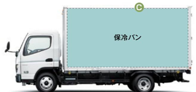
**冷蔵バン** 冷蔵バンは保冷バンに冷凍機を装備したもので、荷室内の温度管理が0°Cまで可能。生鮮食品類の輸送に適切です。
