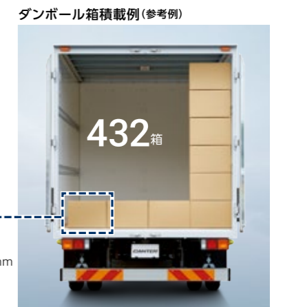
* 最大積載量 4.35トン(超超ロングボデー・バン架装・軽量仕様)の参考例
