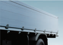
標準アオリ (30mm幅) : 標準荷台、拡幅荷台
