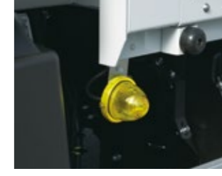
27 車幅灯 写真はLEDタイプ
