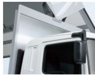
4 フロント外板アルミ平板張り
