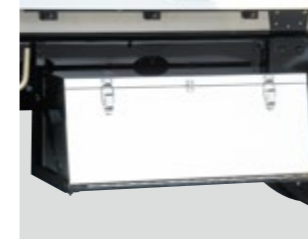
24 工具箱ステンレス製 L=750
