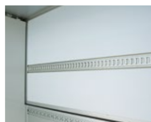
18 サイド内板プラパール(白)張り
