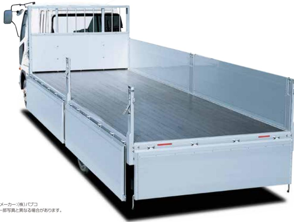
写真はアルミブロック五方開 架装メーカー：(株)パブコ
