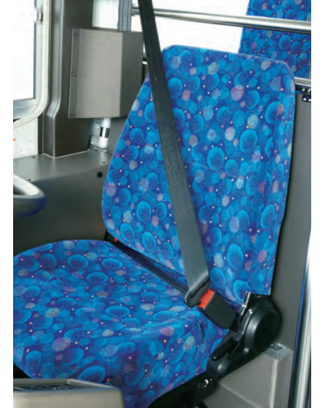
運転席3点多重感知式ELR付シートベルト
