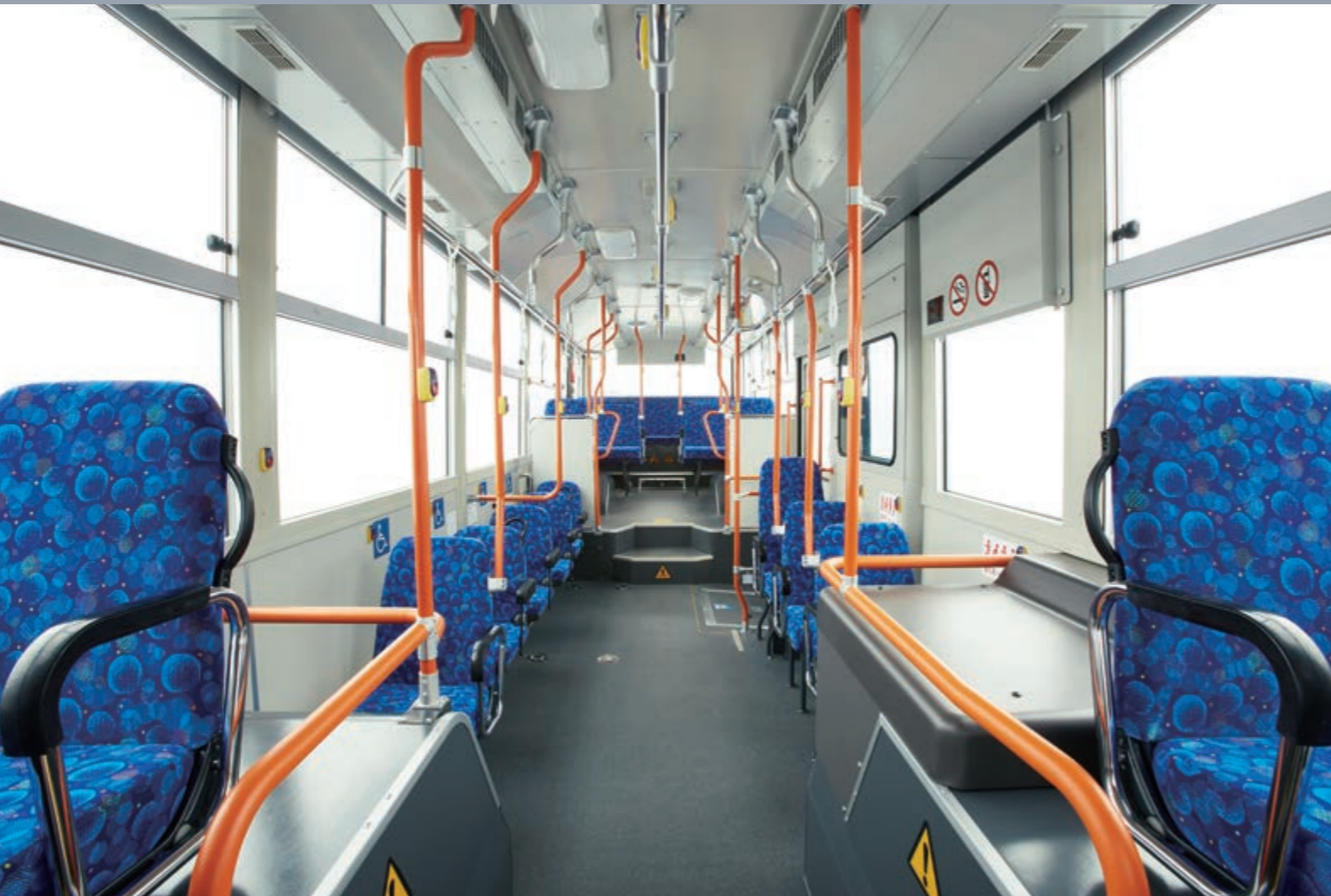
写真はノンステップ車 都市型ラッシュレイアウト 2WG-MP38FMFW 撮影用特別仕様車(イメージ)
