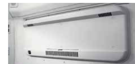
77 蓄冷式リヤクーラー 走行中の蓄冷によりエンジン停止後もベッド部へ冷風を送り続けます。夏場の快適性はもちろん、アイドリングストップによる省エネ効果も期待できます。 ※車種別により異なります。詳しくはディーラーオプション連絡票をご覧ください。
