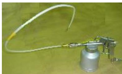
長いノズルを開口部に挿入して塗布します。
