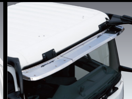
32 フロントウインドバイザー (ステンレス製) スーパーミラー装着車
