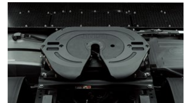
FUSO純正カブラ(ヨースト製)
