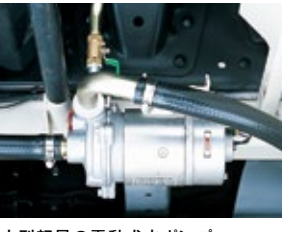
小型軽量の電動式水ポンプ
