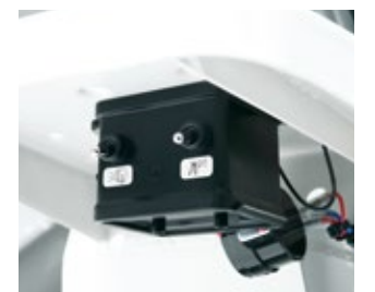
6 水ポンプスイッチ&作業灯スイッチ
