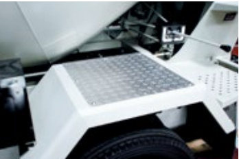
5 フェンダー上アルミ縞板取付*1 架台への昇降時の滑りを防止し、安全を高めます。
