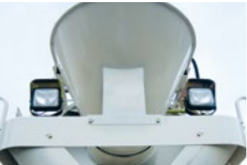
3 作業灯*2 後方部を明るく照らします。
