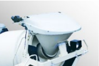
1 電動式ホッパーカバー*1 生コンクリートの投入口を電動でカバーします。
