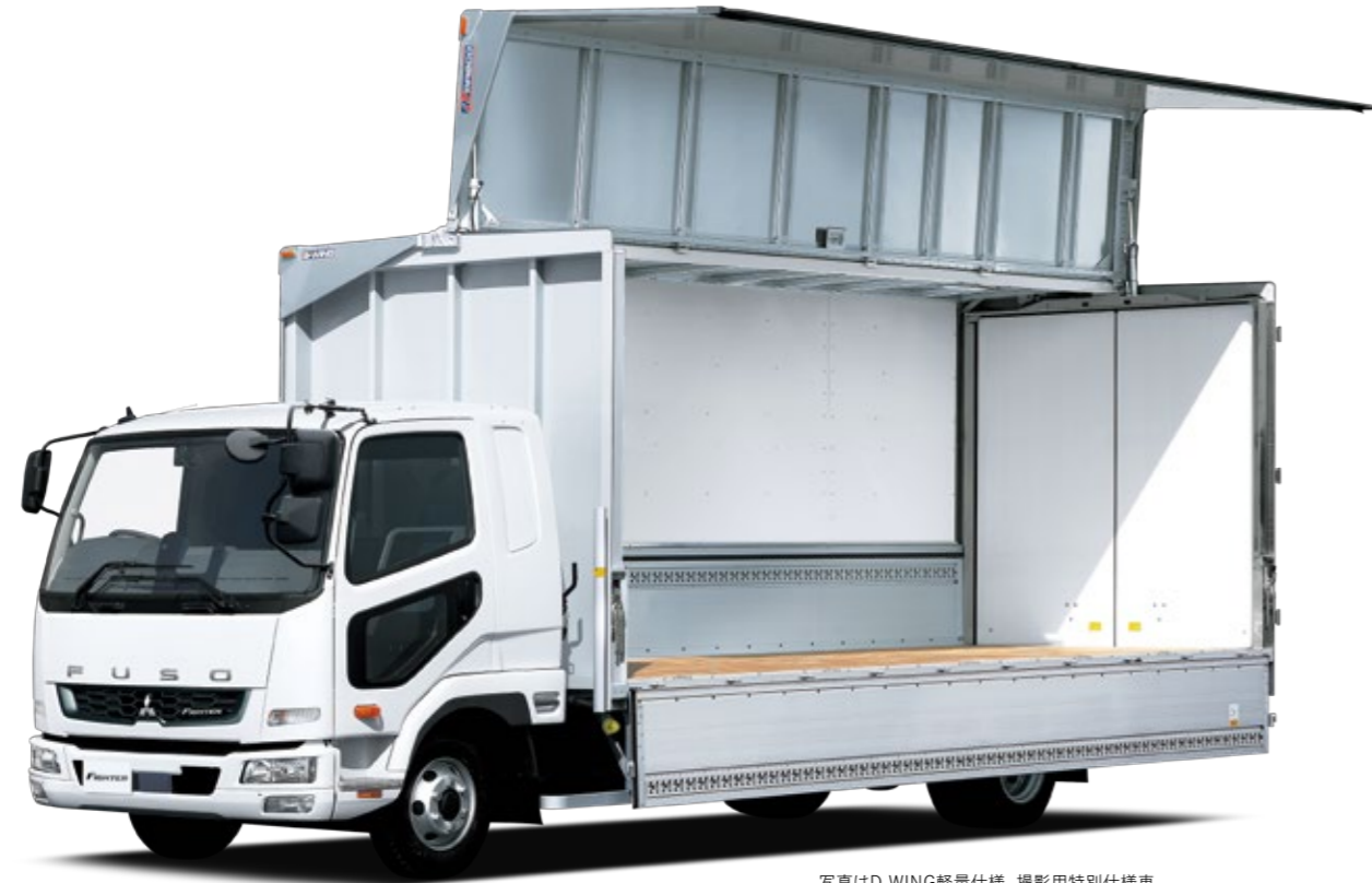
写真はD WING軽量仕様、撮影用特別仕様車 リヤ骨格、ヒンジ、ロック関係はステンレス製のオプションを装着しています。 架装メーカーの仕様変更などにより、一部写真と異なる場合があります。
