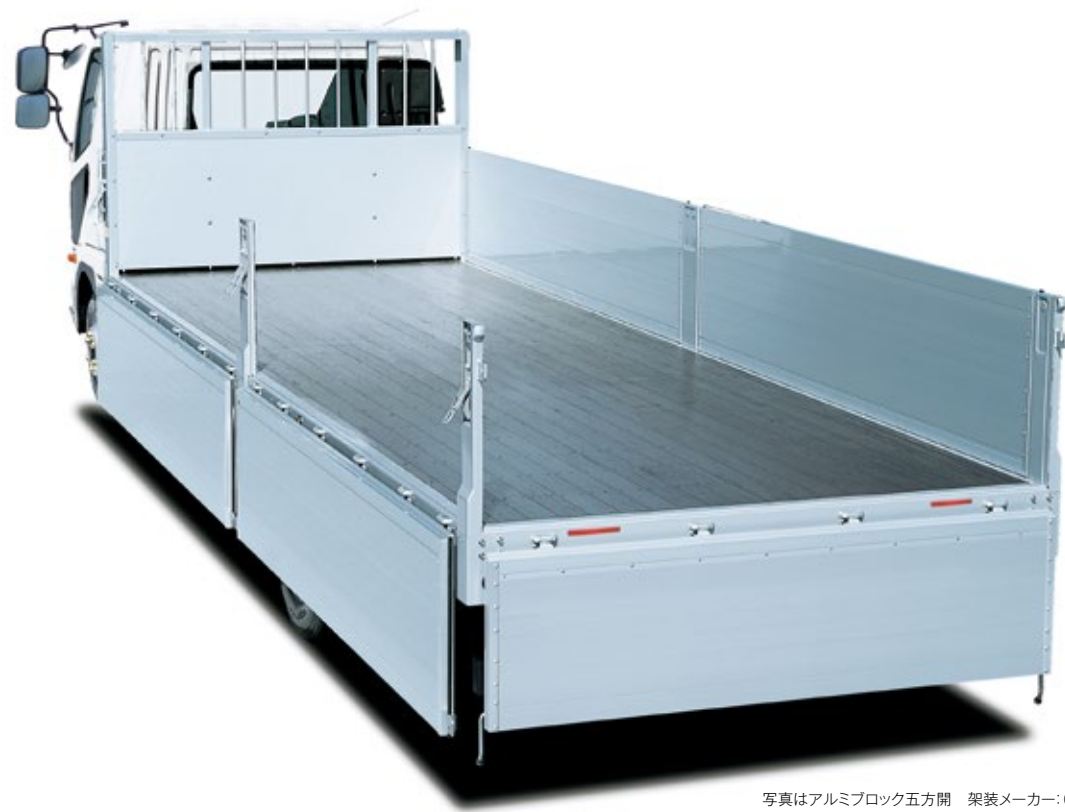
写真はアルミブロック五方開 架装メーカー：(株)パブコ 架装メーカーの仕様変更等により、一部写真と異なる場合があります。
