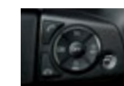
[右サイド] ● 電話 (着信受け・着信拒否・発信・通話終了) ● オートクルーズ (車速セット・キャンセル・復帰)
