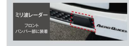
前方の走行車両、静止車両、動いている歩行者を検知。衝突リスクに応じて警告&自動ブレーキを作動させます。
