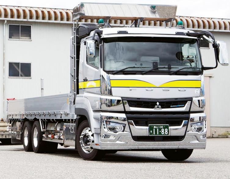
▲新車のスーパーグレートのパールトレーラー。運転席の上部には直射日光を軽減するフロントバイザーを設置。
