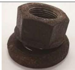
・ホイール・ナットと座金(ワッシャー)とのすき間に潤滑剤を塗布した状態でホイール・ナットの座金(ワッシャー)が円滑に回転するか点検します。
