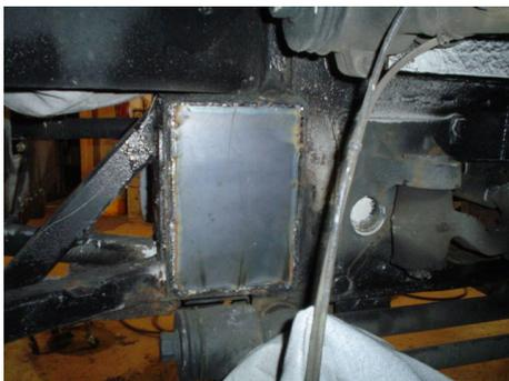
補強板による補修溶接の一例
