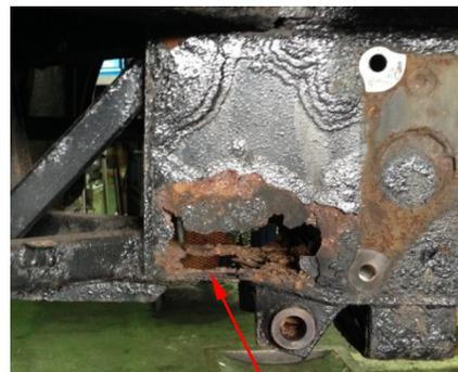
稜線が腐食で欠落しており補強板を溶接できない
