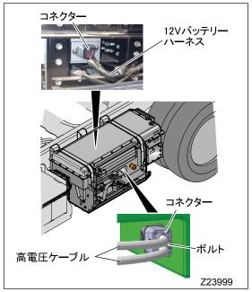
5. 高電圧バッテリーボックスを固定している鋼製バンドを外して高電圧バッテリーボックスを取外します。
