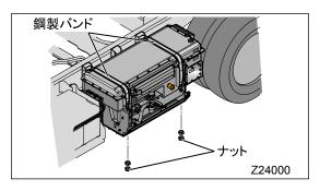
6. 高電圧バッテリーボックスを取外すとき、衝突時の脱落防止フックに引っかからないように高電圧バッテリーボックスを車両後方に移動してから手前に引き出します。
