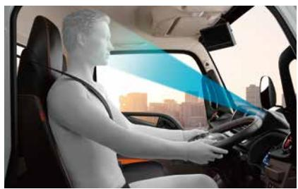
次世代eCanterでは、インテリジェント・ヘッドライト・コントロールなど複数の新たな安全装置を導入予定。また、オプションで白線認識カメラや各種センサーからの情報に加え、顔認識カメラを搭載。顔の動き、左右のわき見や眼の開閉状態を感じて、運転注意力の低下をブザーと画面表示で警告するドライバー注意監視システムも導入が可能に。また、電動化と並行して安全性も追求、お客様の安全運行をサポートする。
