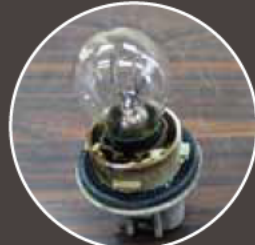
ソケットの腐食
