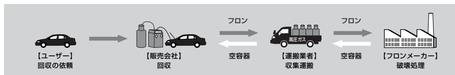
フロン回収・破壊システム
