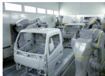
自動車業界初ともいえる「塗装ブース排気処理装置」を備えた塗装ブース。ブース内で発生するVOC(揮発性有機化合物)は塗装工場内に排出されず、すべて回収ダクトより集められ、無害化される。
