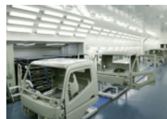
6 キャブは上塗り塗装の前にシーリングやアンダーコートが施される。
