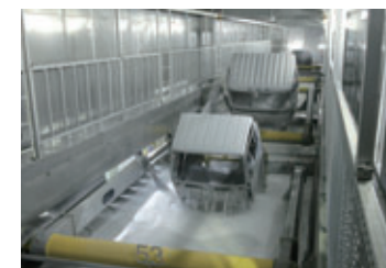
2 「パリオシャトル」により、キャブは回転しながら処理液に浸される。
