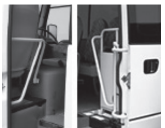
乗降口両側手すり
