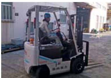
電動フォークリフトによる荷役
