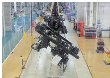
反転組工法 Turnover Assembly Method
