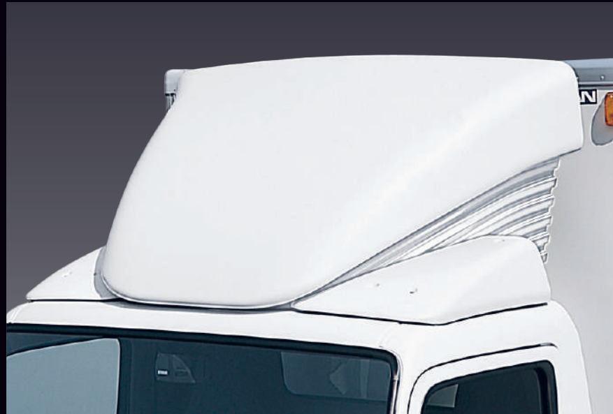
16 ドラッグフォイラー ※ドラッグフォイラーは可変式ではありません。
