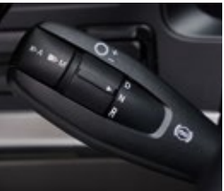
E エンジン補助ブレーキ S シフトダウンブレーキ マルチファンクションレバー
