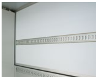
16 サイド内板プラパール(白)張り
