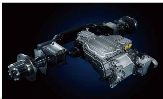
eアクスルは三菱ふそうが独自開発したコンポーネント。トランスミッションやクラッチ、プロペラシャフトのない、高効率の動力伝達とコンパクト構造を実現。シフトショックは皆無なので、ドライバーにもやさしいクルマの実現に寄与している。
