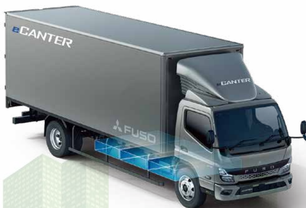
eアクスルは三菱ふそうが独自開発したコンポーネント。トランスミッションやクラッチ、プロペラシャフトのない、高効率の動力伝達とコンパクト構造を実現。シフトショックは皆無なので、ドライバーにもやさしいクルマの実現に寄与している。
