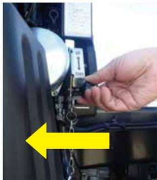
1 キャブが停止しブザーが鳴り止んだら、操作レバーを“DOWN”側ホルダーにしっかり押し込む。
