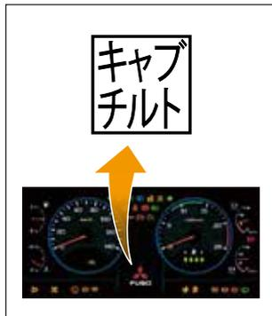
3 スタータースイッチを“ON”位置にし、多重表示モニターに[キャブチルト]を表示しないことを確認する。
