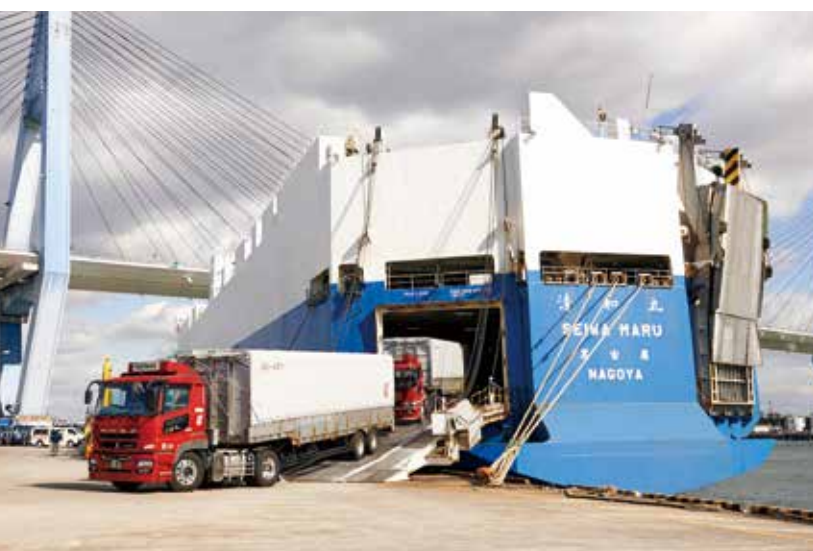
ヘッドレス輸送による荷降ろしの様子
