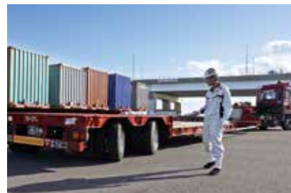
回頭性向上のためリモコン操作でリヤタイヤを切ることができる
