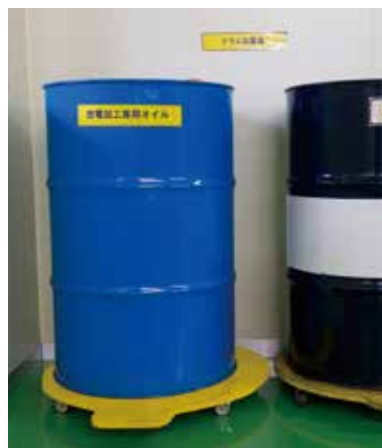
200kg以上のドラム缶も、移動して給油ができるようにキャスター化！一人で楽々移動して隅々まで清掃が行き届きます。
