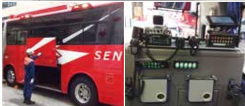
車両は消防車と同じ赤い色。緊急車両として走行するためのサイレン、作業灯のスイッチや無線機等が装備されている。内装は、観光バスと同じ造りで、乗り心地もよく、大量搬送に適している。
