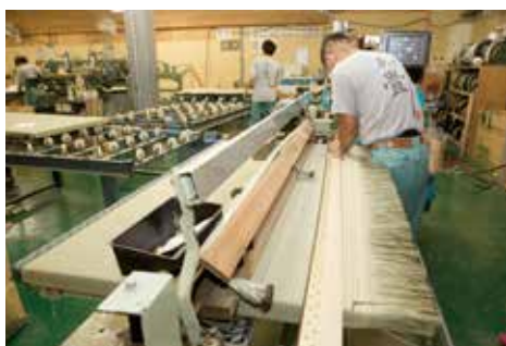
本社工場では、熟練の職人とコンピュータ式畳自動縫着機、自動襖表張機により、1日に畳700畳、襖は600枚という生産体制を実現。即日納品や大量の受注にも対応が可能。
