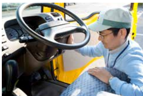
ローザ4WDの運転席。メーターパネルは2WDモデルと同一。2駆モードが存在しないことから、切替スイッチやトランスファレバーはなく、スッキリしたレイアウト。
