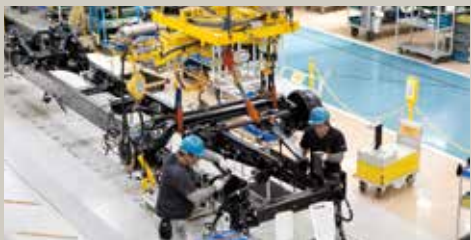
アクスルやパワーバック(エンジン+トランスミッション) は別の建屋で組み立て、空中搬送で供給。
