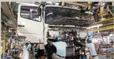
プレス▶溶接組立▶塗装▶簾装組立と各製造工程を 経てきたキャブを車両に搭載。
