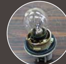
ソケットの腐食
