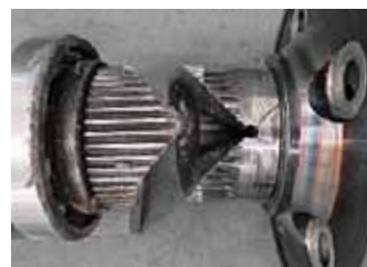
アウトプットシャフト破損状態
