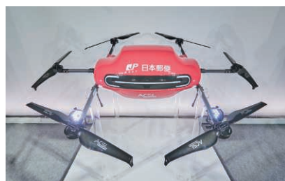
物流用途に特化した新機体を昨年12月に発表。従来のモデルに比べ可搬重量で約3倍、最長航続距離で約3.5倍となる機体を開発中。
