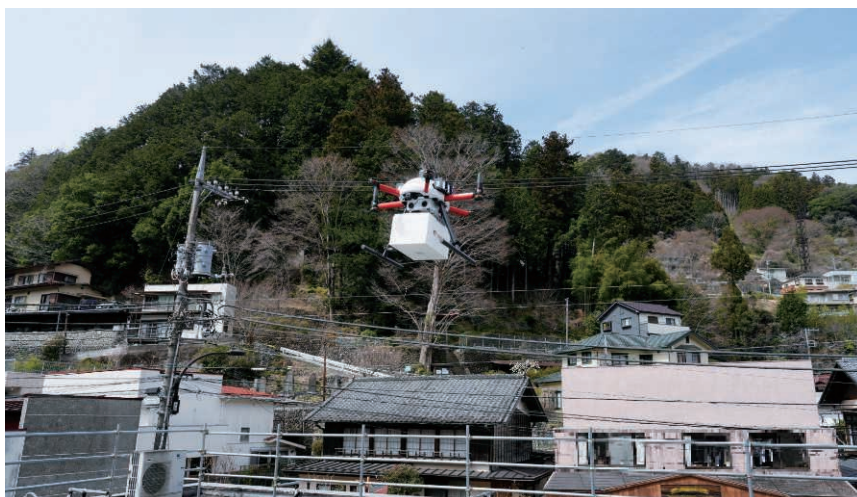
東京都奥多摩町の住宅地で行われたレベル4飛行の実証実験。奥多摩郵便局から配送先の住宅まで往復約4.5km。約900gの箱を持った状態にもかかわらず、この長い道のりをたったの5分で配達しました。
