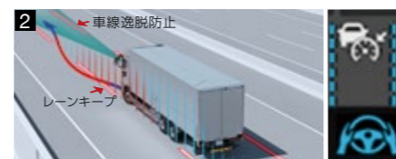
作動条件 (車線幅)3.20~4.40m (車速)レーンキープ:0-90km/h 車線逸脱防止:60-90km/h
