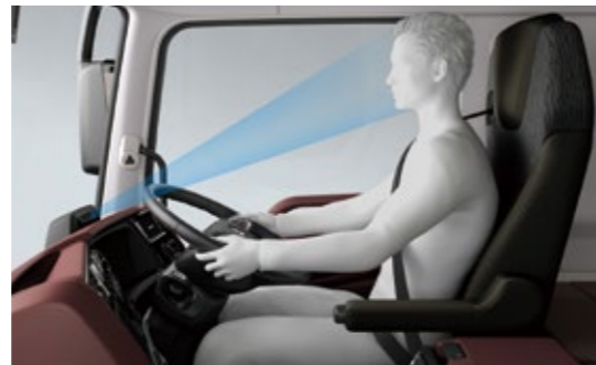
アクティブ・アテンション・アシストでは、赤外線カメラシステムが左右のわき見やまぶたの動きを感知します。
