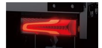
*ストップランプ、テールランプ、ターン(方向指示)ランプ、バックランプ、リヤフォグランプを一体化
