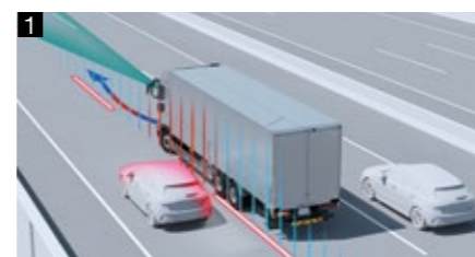
高速走行時の車線変更時のステアリング介入サポート
