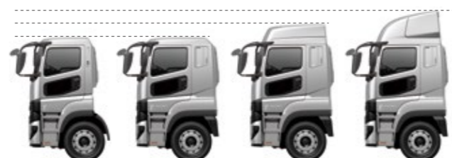
ショートキャブ・スタンダードルーフ フルキャブ・スタンダードルーフ フルキャブ・ハイルーフ フルキャブ・スーパーハイルーフ
