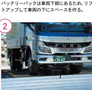
2 バッテリーパックは車両下部にあるため、リフトアップして車両の下にスペースを作る。
