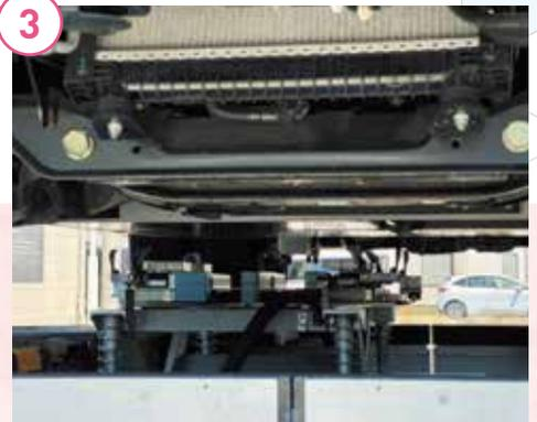
3 ロボットアームが動作を開始。電池残量の減ったバッテリーを取り外す。
