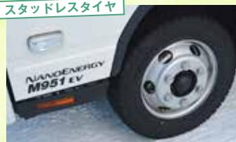
今回は、TOYO TIREのEVトラック専用の「M951EV」を装着。高い氷雪上性能に加え、タイヤの消費が早いEV用に耐摩耗性能を向上させ、走行性がさらにアップ。
