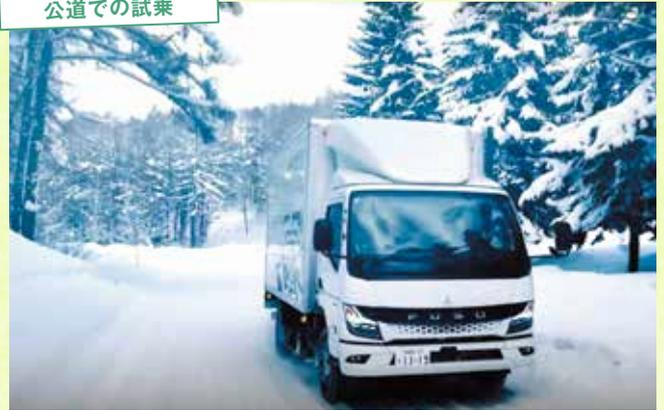
雪の林道で坂道を下りる際、急激なブレーキをかけるとスピンの恐れが。しかしeCanterの回生ブレーキは強さを4段階調整できるため、ブレーキを踏まずに安心して下ることができた。
