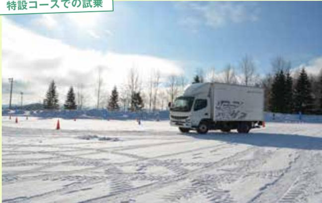
旋回性能や、エンジンの駆動力を路面に伝えるトラクション性能を試したところ、スリップは皆無。空転を防ぐASR(アンチスピンレギュレーター)や車両安定性制御装置のおかげで、快適な走行を楽しめた。
