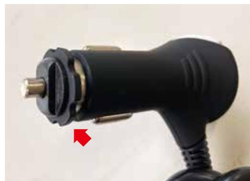
先端部にゴム製の抜け止めが装着された電源プラグの使用による不具合事例が報告されています。
