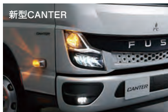
フロントバンパーの角を丸く整えることで空力抵抗を抑えつつ、2024年モデルより親しみやすいフォルムに。
