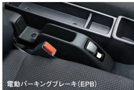
電動パーキングブレーキ(EPB) *積載量1.5tクラス(FBA00/FDA00)とエコモデルは非装着(従来の手引きパーキング)になります。
